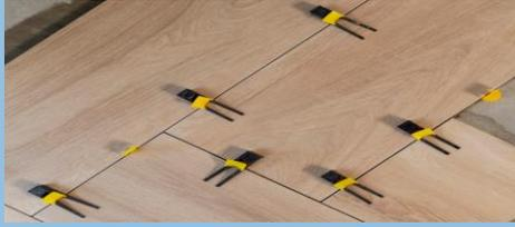
Le dispositif d'entretoise et de nivellement pour la pose de produits en dalles notamment le carrelage, ou la faïence est constitué d'un support muni d'une embase et d'un élément séparateur. Cet élément séparateur est positionné entre deux carreaux pourvu d'une fenêtre traversante et un coin presseur d'une forme triangulaire destiné à être inséré dans ladite fenêtre traversante.
